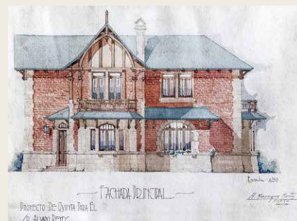
Quinta para Álvaro Reyes, 1930, acuarela. Chalet “inglés” en ladrillo a la vista, con chimenea, esquinas y marcos de ventanas y puertas en piedra. Fuente: Archivo AMM.
